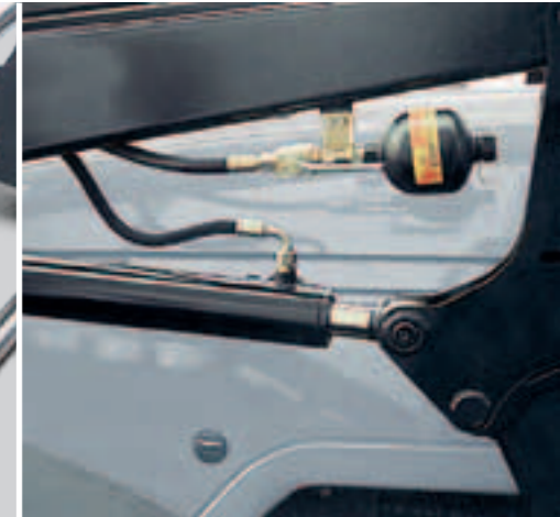
COMFORT-DRIVE – die Ausrüstung zur Abfederung des Frontladers bei Transportfahrten mit angebaute Frontlader – das schont den Fahrer und den Traktor (auch nachrüstbar).
