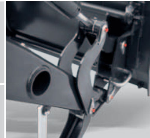
Euro-Schnellwechselrahmen mit angebaute Werkzeug.
