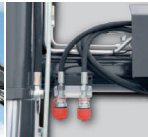
Dritter Steuerkreis zur Bedienung von hydraulischen Werkzeugen z. B. mit Greiffunktion – Nachrüstung.
